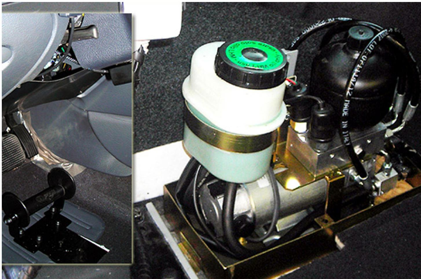
AS01 è un ausilio di guida per disabili, idoneo ad alleggerire l'azionamento del pedale del freno di servizio o della frizione.
