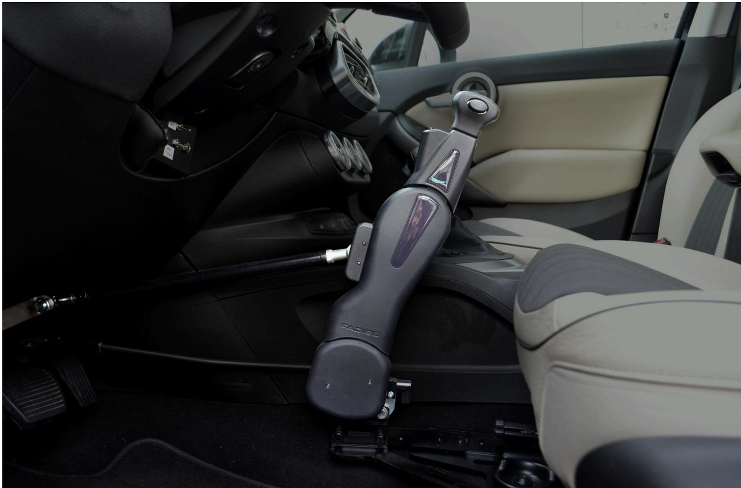
Dispositivo che combina la movimentazione del pedale del freno con spinta manuale in avanti, con l'accelerazione meccanica tramite rotazione della parte superiore della leva attorno al proprio asse, che va ad azionare un rinvio ad asta telescopica fissato sul pedale dell'acceleratore.
