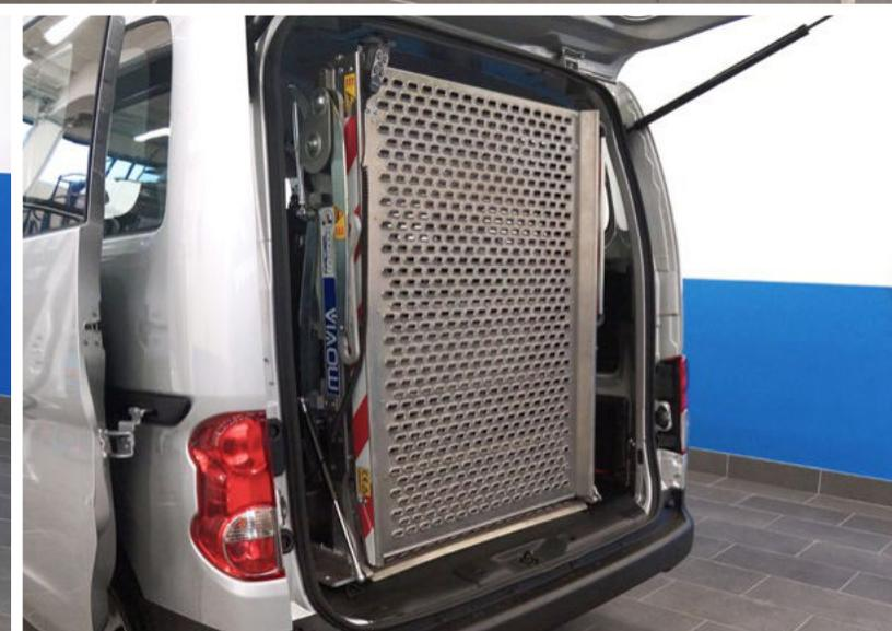
La rampa MOVIA motorizzata è un dispositivo con azionamento automatico idoneo per il trasporto che facilita ai disabili l'accesso al veicolo e può essere impiegata anche per il carico/scarico di altri mezzi ed attrezzature come ad esempio i carrelli per i servizi di catering, ospedalieri, service audio/luci, distributori automatici.
