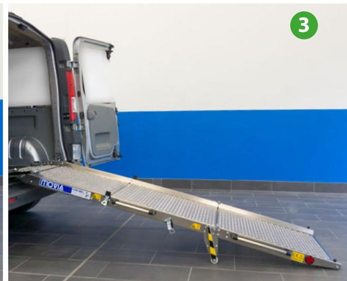
La Rampa MOVIA costituisce un dispositivo per il trasporto che facilita ai disabili l'accesso al veicolo. Può essere impiegata anche per la movimentazione di altri mezzi ed attrezzature come carrelli per i servizi di catering, ospedalieri, service audio/luci, distributori automatici.
